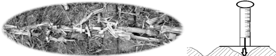
Şekil 4. Prototip sap ezme-kesme makinasının iz derinliğinin ölçülmesi Figure 4. Measuring the trace depth of the prototype handle crushing-cutting machine
