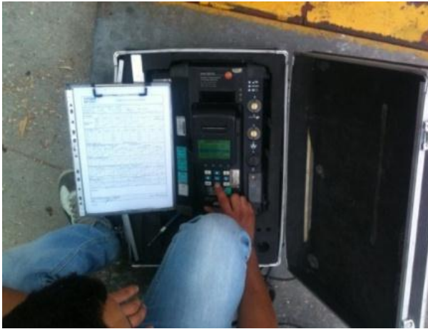
Şekil 2. Baca gazı ölçüm cihazı kalibrasyonu
