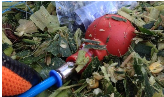
Şekil 2. Basınç algılayıcı kauçuk küre ve hidrolik hortum
