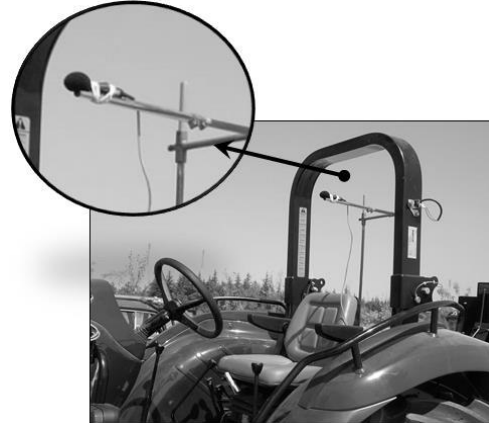
Şekil 5. Ses ölçüm mikrofonunun yeri Figure 5. Location of the sound measurement microphone
