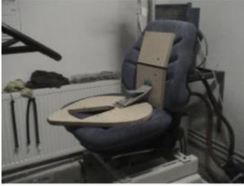
Şekil 3. Traktör sürücü koltuğu deney ünitesi Figure 3. Tractor driver seat test unit
