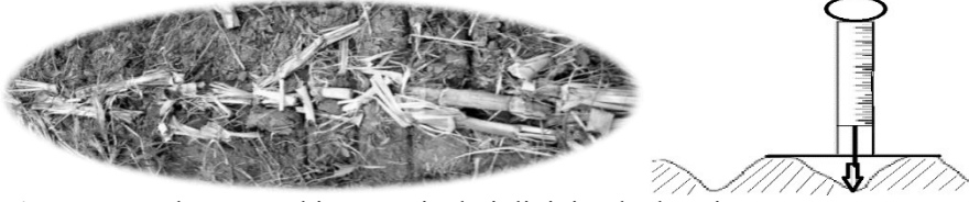
Şekil 4. Prototip sap ezme-kesme makinasının iz derinliğinin ölçülmesi
