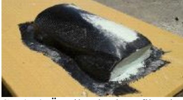
Şekil 6. Üretilen karbon fiber kabuğun kurumaya bırakılması ve macun uygulaması Figure 6. The produced carbon fiber shell and allowed to dry paste application
