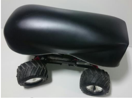
Şekil 7. Üretilen karbon fiber kasanın son hali Figure 7. Produced carbon fiber casing finalized
